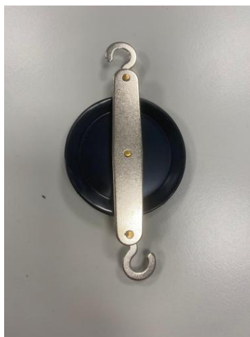
Polea simple con ganchos de suspensión.
