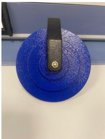
Polea múltiple / sistema de varias gargantas.
