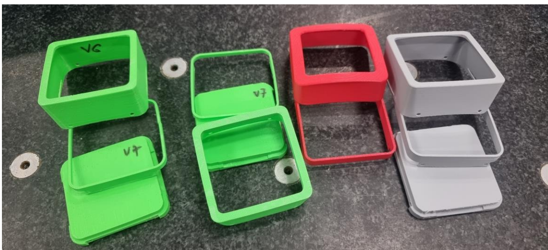
Figura 5. Distintas pruebas realizadas sobre la estructura rígida del simulador
