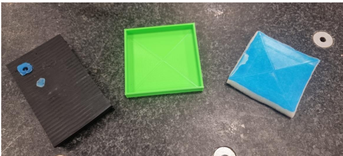
Figura 3. Pruebas realizadas con moldes abiertos y cerrados para conseguir la piel del simulador
