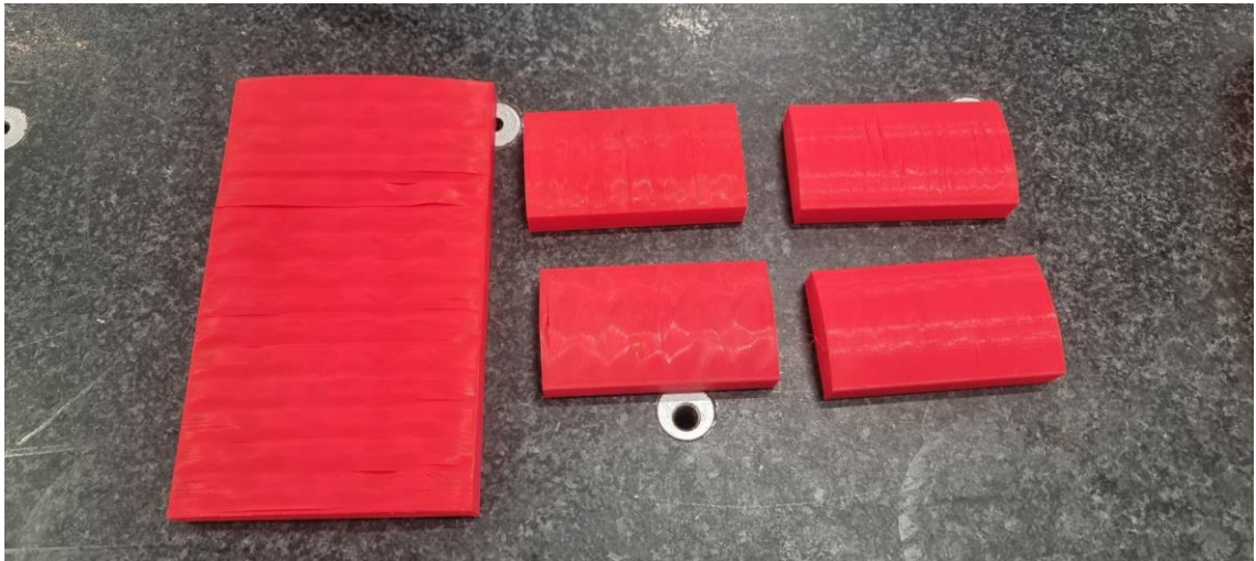
Figura 1. Pruebas realizadas con FFF flexible para conseguir propiedades mecánicas del músculo
