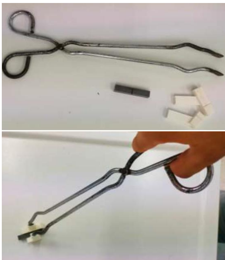
Figura 2. Ejemplo de un accesorio para manejo de probetas charpy (en blanco), adaptado a unas pinzas ya disponibles en el laboratorio de prácticas.
