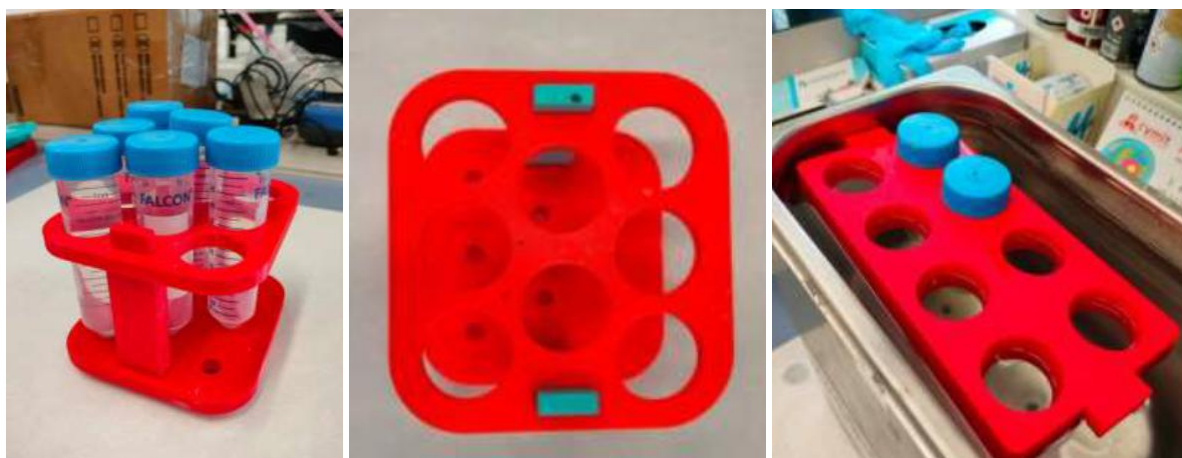
Figura 1. Diferentes elementos de apoyo como soporte de tubos falcon para su uso en prácticas. Estos soportes permiten colocar estos tubos en la poyata de forma vertical y sumergirlos en baños de ultrasonidos de forma segura.
