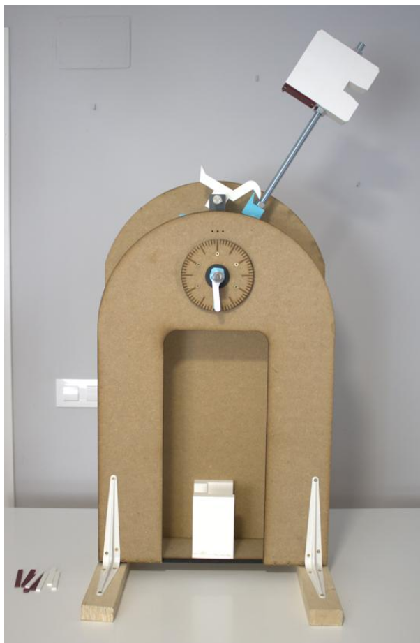
Figura 5. Prototipo del equipo charpy para evaluar la resistencia al impacto en polímeros. La mayor parte de los elementos, especialmente aquellos sujetos a grandes esfuerzos mecánicos fueron previamente diseñados y fabricados mediante impresión 3D.
