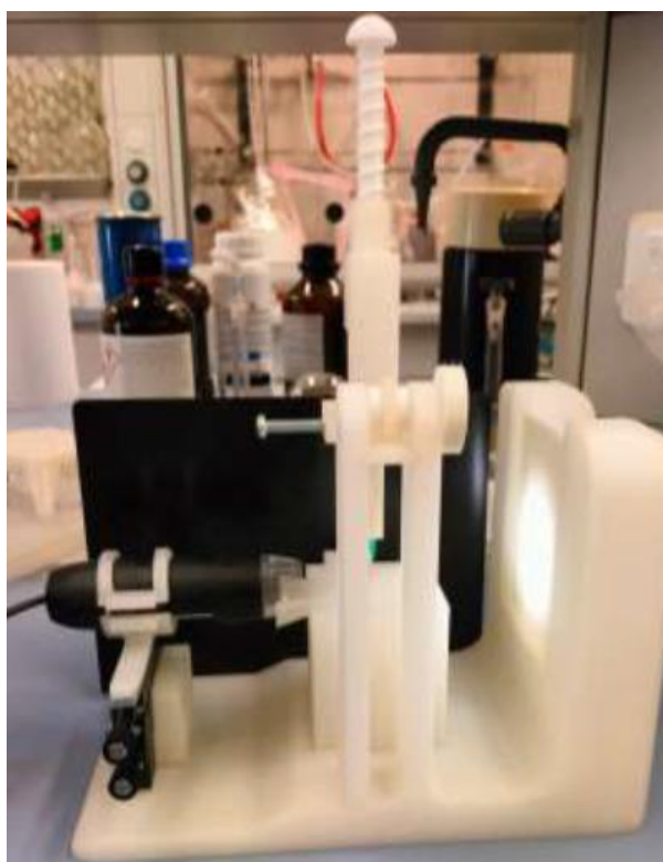
Figura 4. Prototipo del equipo de ángulo de contacto. La mayor parte de los elementos fueron fabricados mediante impresión 3D.
