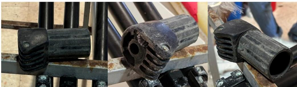
Enchufe para alargador de mástil 4 poleas para tablas de windsurf. El alargador va encajado en esta pieza y por regla general este es indispensable, sobre todo cuando se trata de velas de gran envergadura. Estas piezas sufrían constantemente roturas y desgastes.
