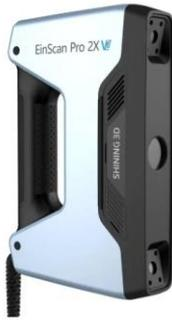
Este escáner de mano cuenta con tres modos de escaneo: escaneo rápido, escaneo HD portátil, escaneo fijo con o sin plataforma giratoria; y varios modos de alineación entre los que se encuentran: de marcadores, de texturas, manual, ...
