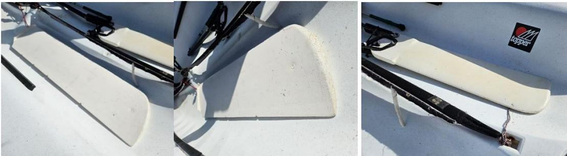
Pala de timón en fibra de vidrio que puede tener un núcleo en espuma de PVC. Este tipo de palas se encuentran en el mercado por un precio aproximado de 150 € en adelante.
