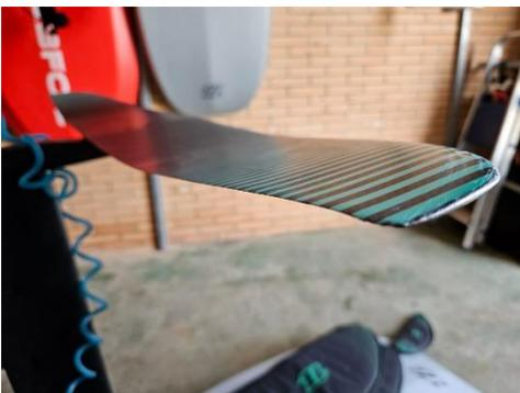
Alerón trasero del foil fabricado en fibra de carbono. Este tipo de piezas cuentan con un núcleo de paulinova con insertos de ABS. Si el tamaño del alerón trasero es pequeño se dice que el foil es más técnico, de modo que este tipo de alerón en grandes dimensiones se suele usar para principiantes.
