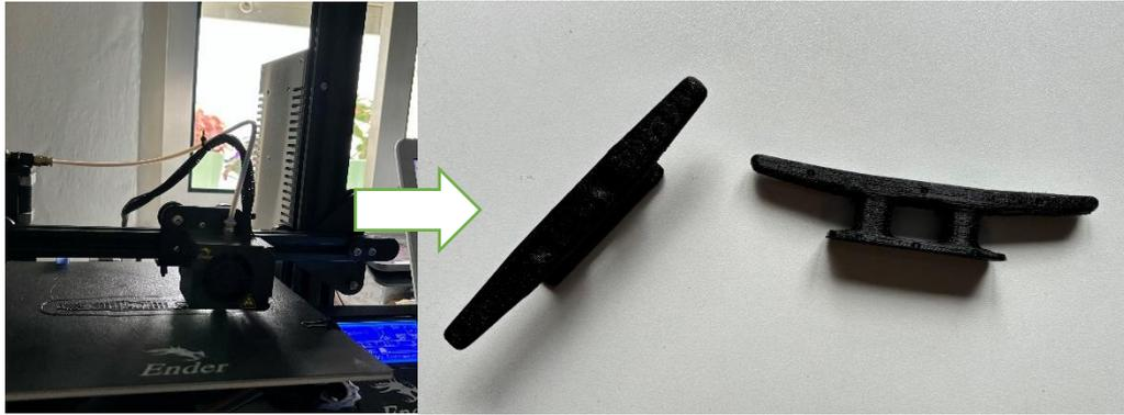
La impresión tal y como se comentó duró 7 horas y el filamento usado fue nylon de la marca overture de 1,75 mm de diámetro.
