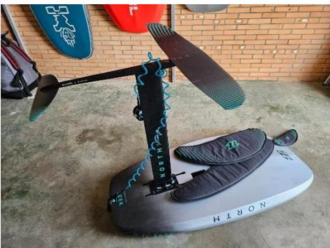
En esta imagen se puede apreciar el foil por la parte inferior. La estructura anclada suele fabricarse en aluminio y cuenta con dos alerones o aletas
