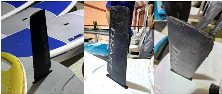
Quilla para tabla windsurf, presenta desgaste en cantos. Este tipo de piezas suele estar fabricada a partir de nailon reforzado con fibra.
