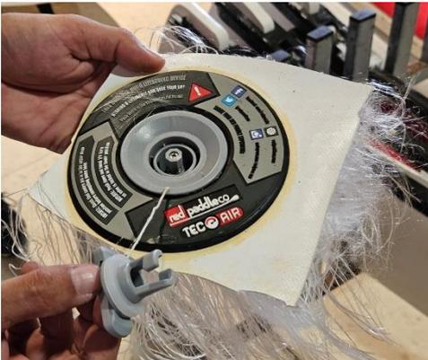
Válvula de aire para embarcaciones inflables que permite el control y regulación del flujo de aire. Esta pieza se abre, cierra u obstruye de forma parcial los orificios de salida del aire. Está compuesto por dos piezas y tiene un precio que ronda los 5 €
