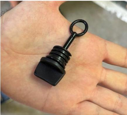
Tapón de drenaje para Laser. Se sitúa en la popa de la embarcación. Requiere de una pieza para su anclaje. El juego de ambas tiene un coste aproximado de 6 €
