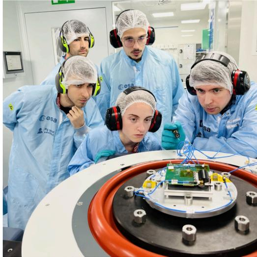
**Figura 2:** Estudiantes inspeccionando los resultados del test de vibraciones. (ESEC, Bélgica)
