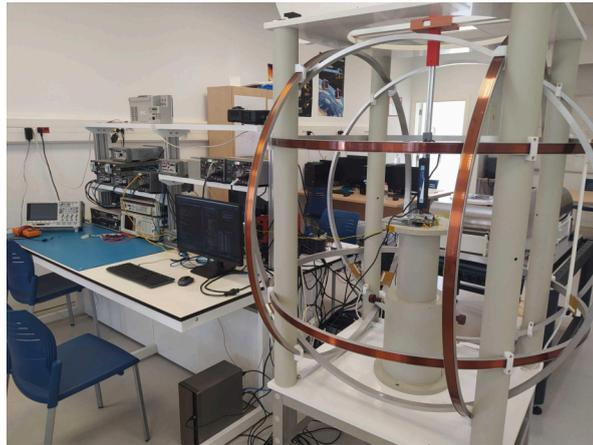
**Figura 4:** Equipo usado para la simulación del campo magnético en órbita
