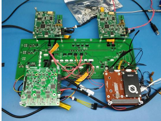
**Figura 6:** Subsistemas de vuelo integrados en la placa de desarrollo para su ensayo funcional.
