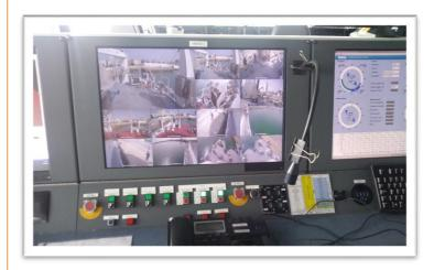
Para dicha actividad se ha contado con dos señales de entrada procedentes de un video VHF y un DVD, como simuladores de dos cámaras distintas, se cuenta con monitores para realizar la visualización de las señales.
