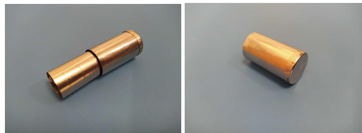
Figura 1.2: Escudo magnético que han realizado los estudiantes de UCA nFly y que está compuesto por dos capas concéntricas de \mu -metal.
