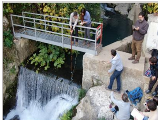
Fotografía 3. Realización de aforo de caudal en la Cueva del Gato.
