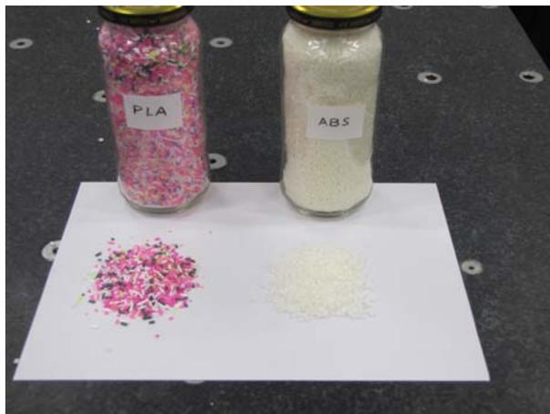
**Figura 2.** Pellets obtenidos para el reciclado de PLA y ABS.
