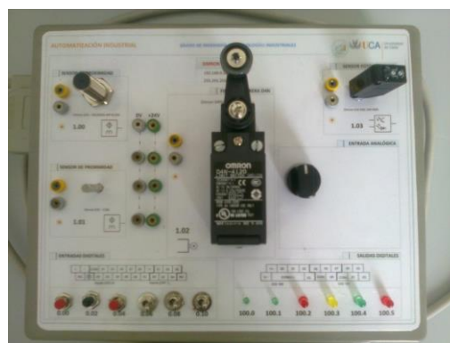
Unidad de prácticas para sensores industriales y Labview
