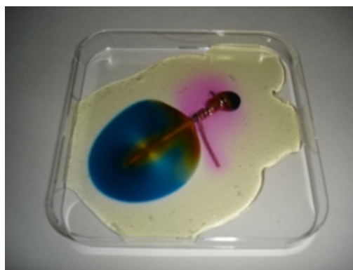
Figura 2. Clavo de hierro en matriz de agar con cable de cobre. El ejercicio consiste en exponer las semirreacciones que tienen lugar y explicar el origen y naturaleza de los diversos colores del estado final.
