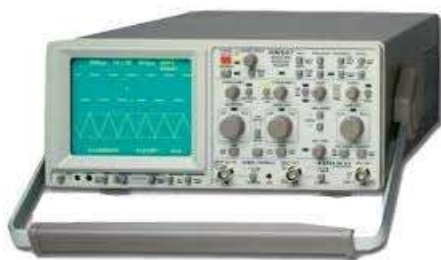
Figura 1. HAMEG 507, osciloscopio analógico-digital, disponible en el Laboratorio de Electrónica del CASEM
