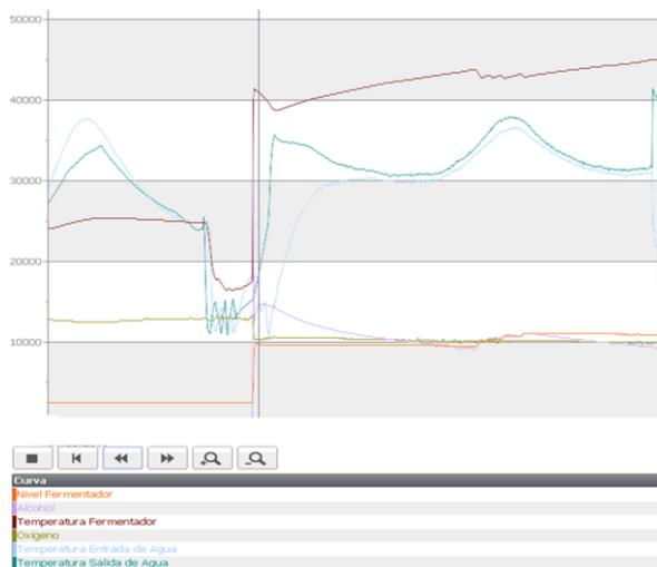
**Figura 1:** Captura de pantalla del SCADA durante la fermentación acética
