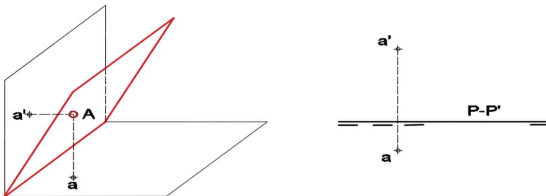
Figure 17: Representación espacial y diedrica del plano contenido en la línea de tierra.
