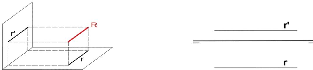
Figure 8: Representación espacial y diedrica de la recta paralela a la línea de tierra.
