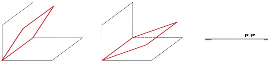
Figure 16: Representación espacial y diedrica del plano contenido en la línea de tierra.
