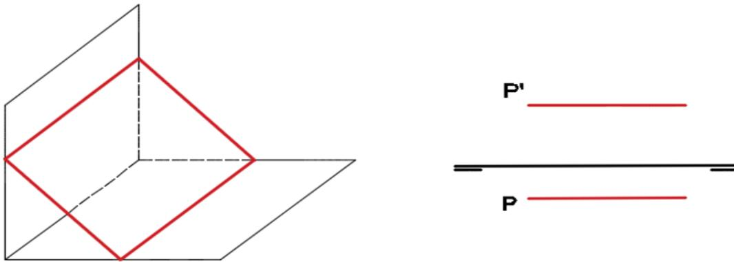
Figure 15: Representación espacial y diedrica del plano paralelo a la línea de tierra.
