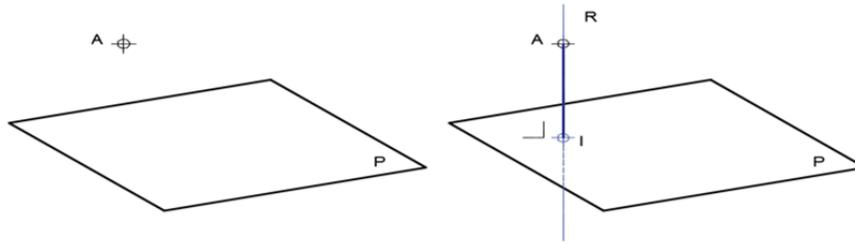
Figure 23: Distancia de un punto a un plano.
