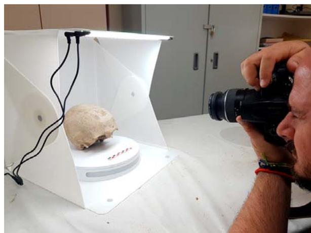
Figura 1. Set de estudio fotográfico FOLDIO 360, útil para la toma de fotografías de piezas arqueológicas.
