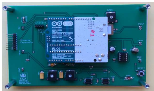
Figura N.3: Conexión de la tarjeta Arduino® UNO a la cara inferior de la tarjeta de emulación proyectada.
