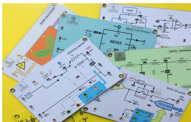
Figura N.4: Distintas carátula para diferentes prácticas utilizando la tarjeta para simular circuitos eléctricos, osciladores, líneas de transmisión, tratamiento digital, etc.
