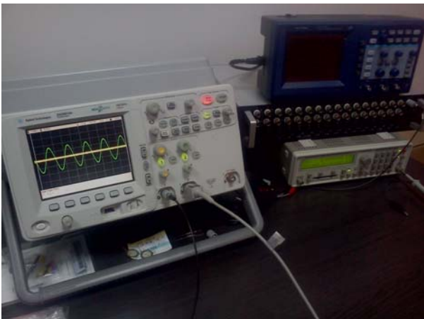
Figura 7. Disposición en el laboratorio del osciloscopio que está conectado a internet. Este osciloscopio posee una dirección IP fija, que fue suministrada por nuestro CITI.
